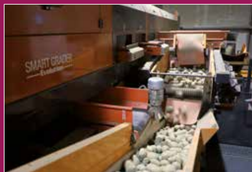
Om de elektronische sorteermachine optimaal te laten werken, is het van belang de kleine pootgoedmaat eraf te draaien en deze later te sorteren.
