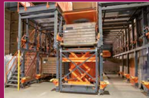
De turtle van de robot brengt de kist omhoog naar de kistenkantelaar.
